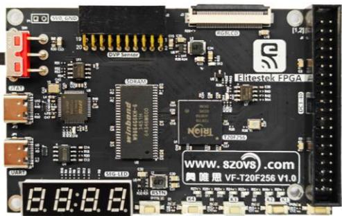
VF-T20F256 FPGA开发板
