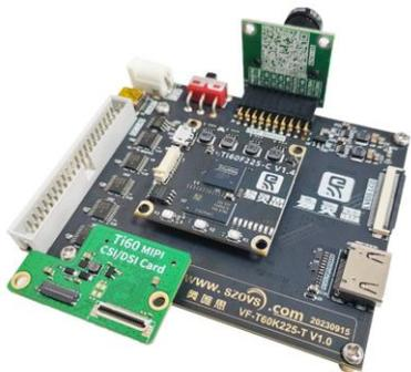
VF-Ti60F225 FPGA开发板
