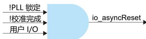
PLL 锁定信号必须来自专用 `io_systemClk` PLL。用户 I/O 是指通常连接到外部 GPIO 开关的用户自控信号。但是，您可以使用软逻辑从另一个源设计此信号。用于生成 `io_asyncReset` 的所有相关信号都必须具有高电平有效属性。
